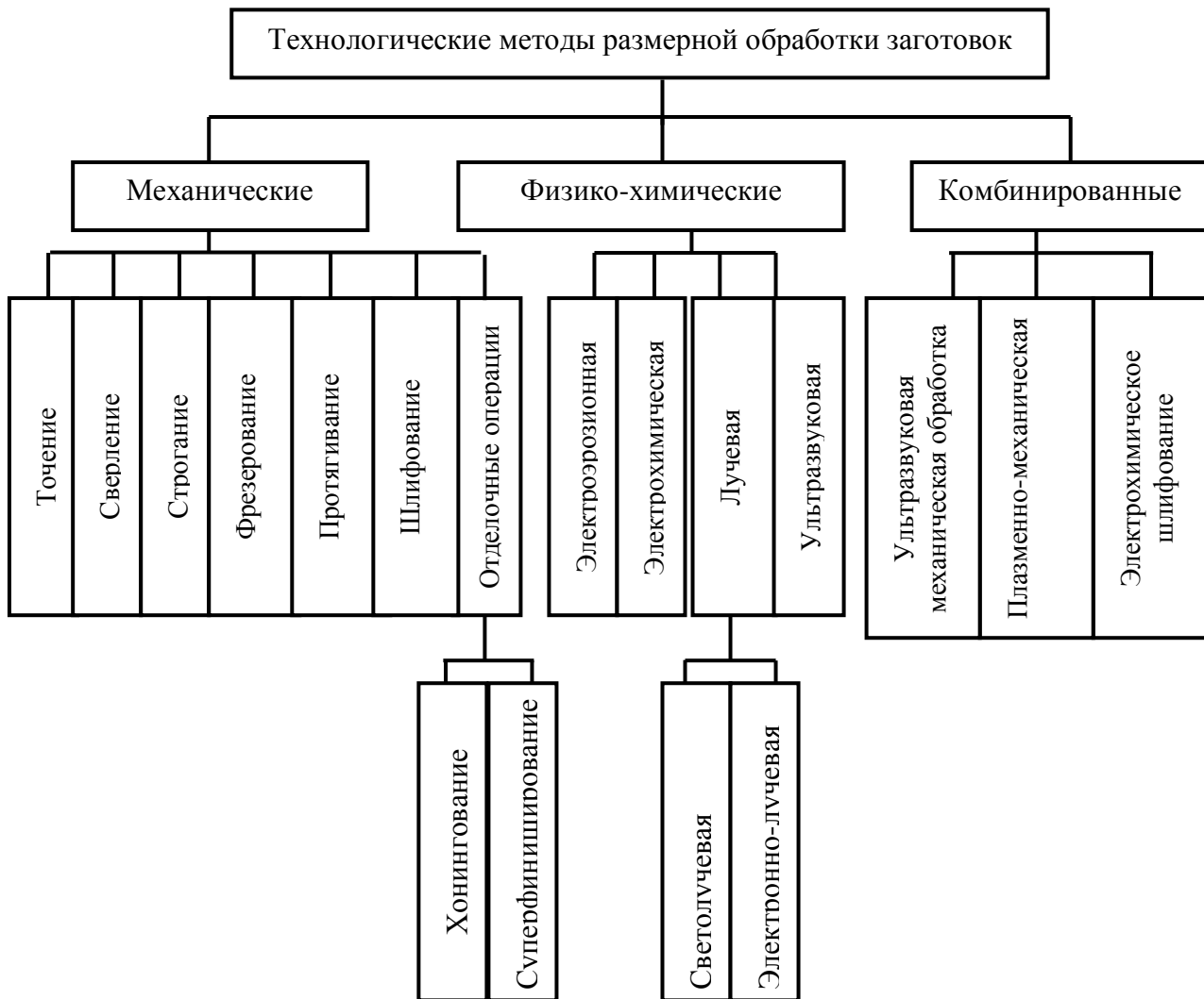
Рис.7.5. Технологические методы размерной обработки деталей машин
